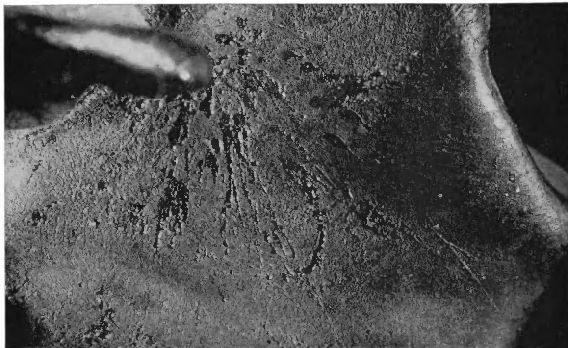
Явления разбрызгивания расплавленного вещества на поверхности образцов Сихотэ-Алинских метеоритов (при увеличении около 18 раз). Вверху — сложный рисунок поверхностной структуры коры плавления; внизу — разбрызганные капли на поверхности метеорита
